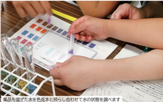
薬品を混ぜた水の色見本と照らし合わせて水の状態を調べます
