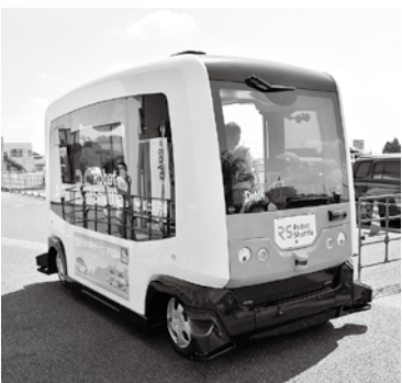
今後の活用が期待される自動運転サービス車両
