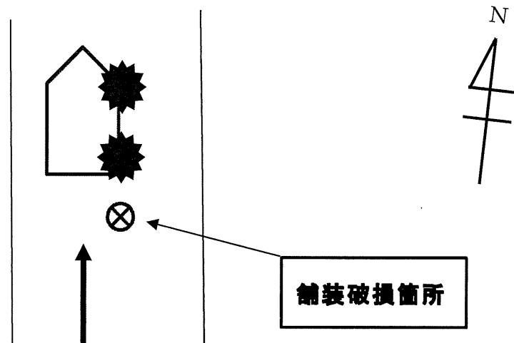
車両が市道を北進したところ、舗装に深さ9cmの穴があり、そこに右側のタイヤ2本が落ち、損傷したもの。
