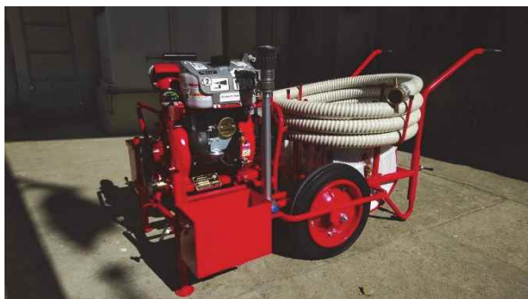
写真 2.11 配備した D 級可搬ポンプ
