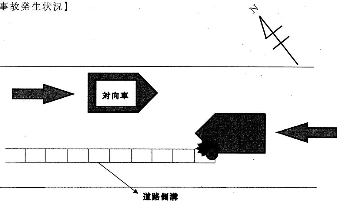
対向車とのすれ違いの際に段差が9cmある側溝蓋に乗り上げた結果、U字溝及び側溝蓋に破損があったため蓋が跳ね上がり、車両のラジエーター・ホースが破損したもの。
