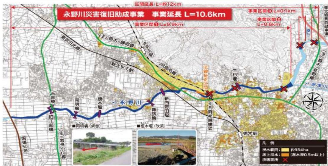
河邊掘削や堤防嵩上げ、橋梁架替等により、令和元年東日本台風と同規模の洪水に対し、浸水被害を解消する
