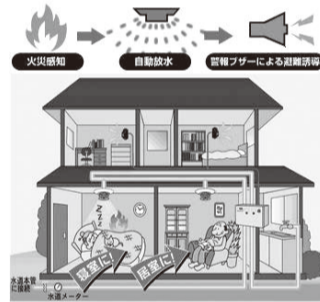
住宅用スプリンクラー設備の一例
