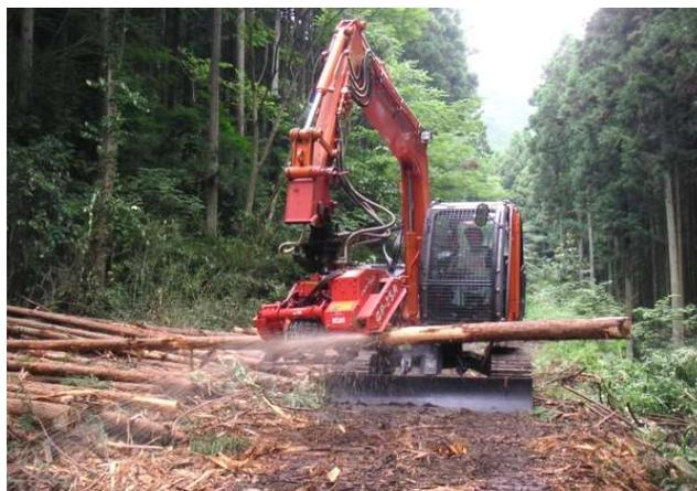
プロセッサによる造材作業
