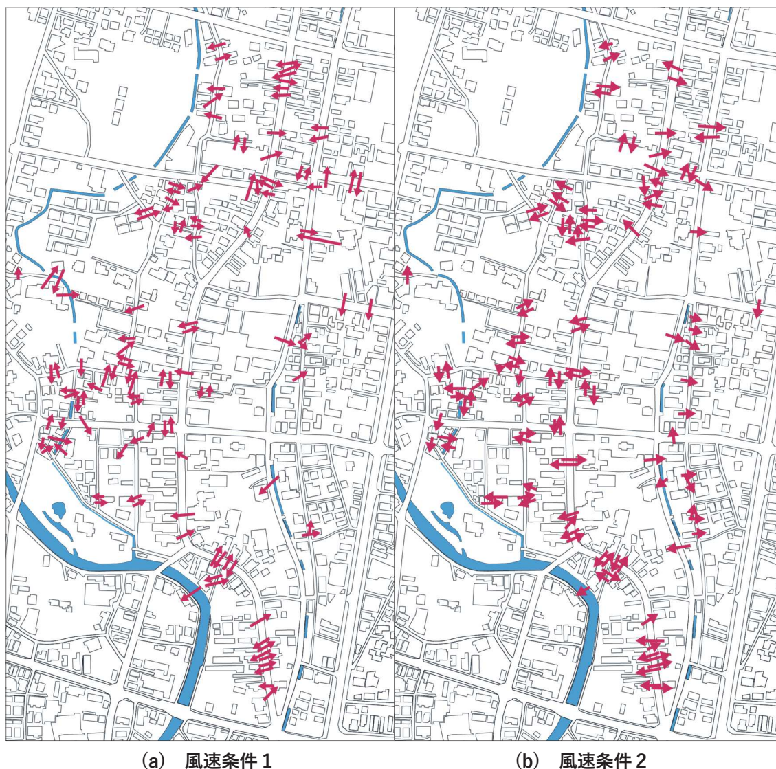
図 3.4.23 地震火災時において道路を跨いだ延焼経路
