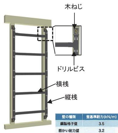
図 4.3.6 鋼製格子フレーム補強 http://www.taishin.metro.tokyo.jp/pdf/dl_005_1801.pdf
