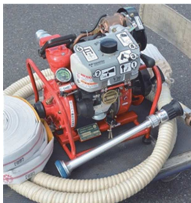
写真 4.2.5 D級ポンプ
