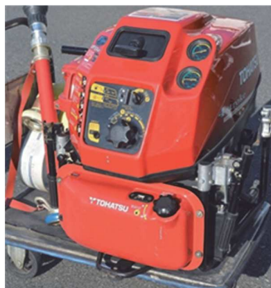
写真 4.2.6 B級ポンプ
