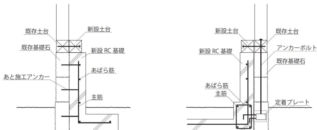
図 4.3.7 布石基礎の補強案
